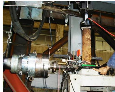
Σχήμα 3β. Επιβολή ανακυκλιζόμενης διατμητικής παραμόρφωσης με την ταυτόχρονη επιβολή ελεγχόμενου σταθερού εντατικού πεδίου κάθετου στο επίπεδο των στρώσεων.
