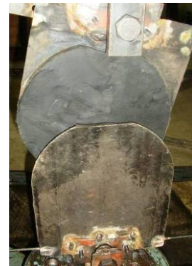
Σχήμα 6β. Αστοχία κυλινδρικού δοκιμίου διαμέτρου 250mm.
