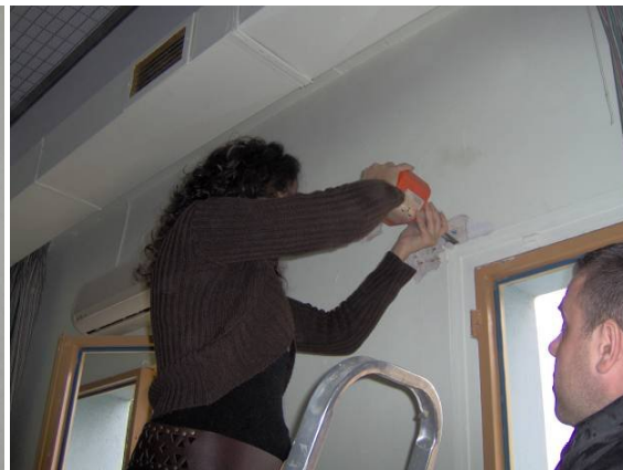
Εικ. 19 Εκτέλεση κρουσιμέτρησης σε πρέκι
