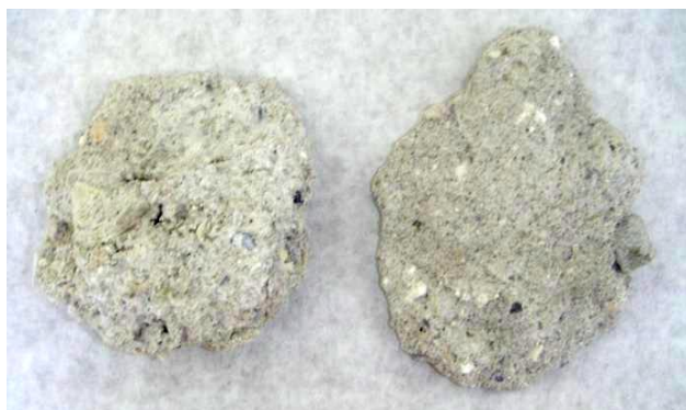
Εικ. 28 Το πρώτο δείγμα από εσωτερική φέρουσα οπτοπλινθοδομή του πρώτου ορόφου της πτέρυγας Β
