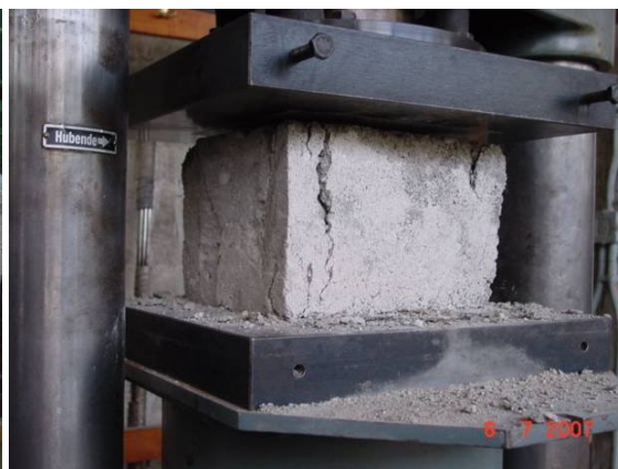
Εικ. 27 Προχωρημένη θραύση τσιμεντόλιθου
