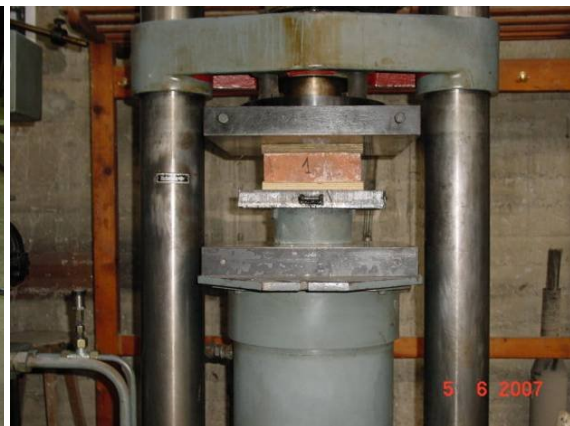
Εικ. 21 Έναρξη δοκιμής σύνθλιψης πλίνθου
