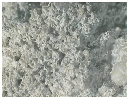
Εικ. 29 Μεγάλο ποσοστό μικρών πόρων μέσα στην κονία και μεγάλη αναλογία λεπτόκοκκων αδρανών (Στερεοσκόπιο x8)
