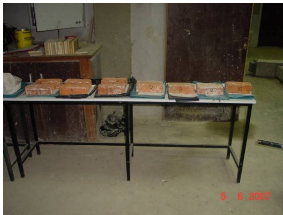
Εικ. 20 Δέκα πλίνθων προς εργαστηριακή δοκιμή, μετά τον καθαρισμό τους
