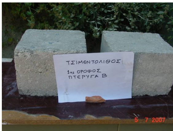
Εικ. 26 Τσιμεντόλιθος μετά την αποκοπή και διαμόρφωση δύο δοκιμίων
