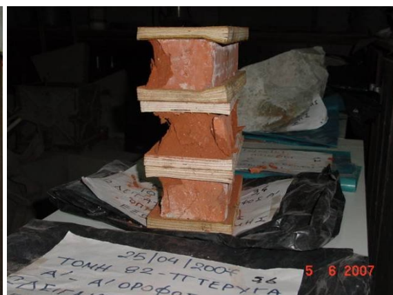
Εικ. 23 Τυπική μορφή αστοχίας πλίνθων
